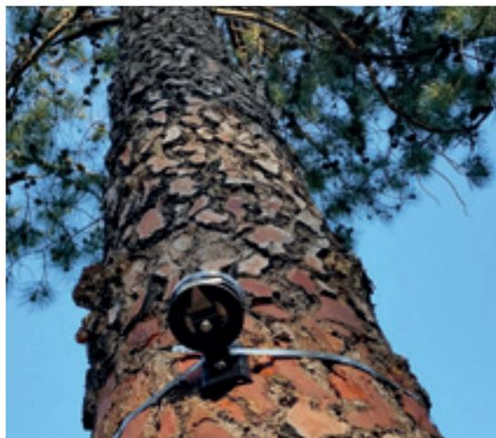
*Dendrometer zur Messung von Stammdurchmesserschwankungen*
