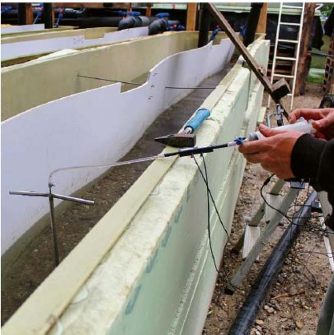
Abb. 3: Beprobung der Sedimentwässer in den Fließrinnen für die Bestimmung der Konzentrationen und stabilen Isotope des gelösten Sauerstoffs (Standort Aquatische Systembiologie in Freising/TUM). Die vorsichtige Extraktion erfolgt unter Luftabschluss mit einer Spritze, die an eine spezielle Entnahmelanze gekoppelt ist (Foto: Luisa Daxeder).
