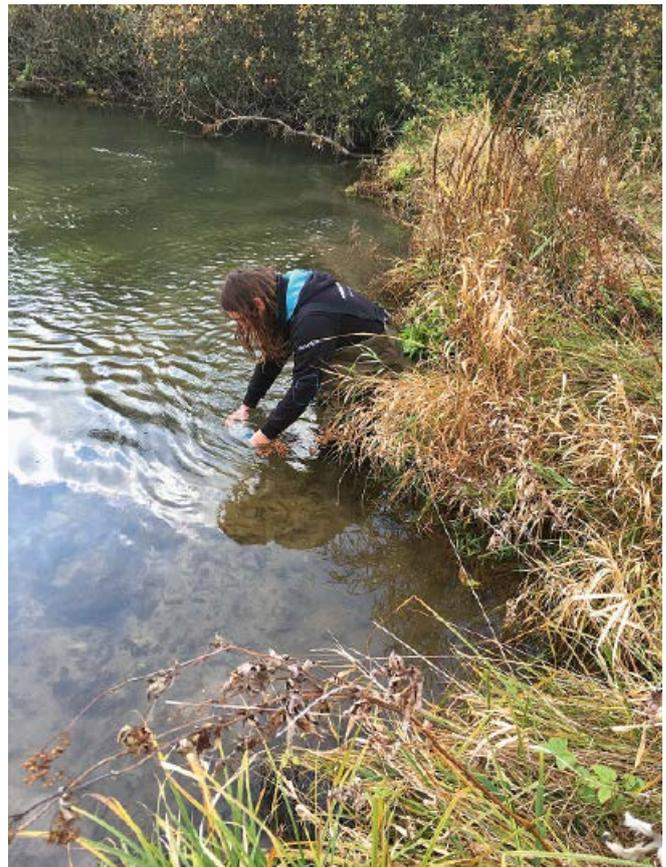
Abb. 4: Befüllen einer Probenflasche für die Radon-Tracer Methode, um Grundwasserzuflüsse quantifizieren zu können. Durch vollständiges Untertauchen der Probenflasche und den Verschluss unter Wasser kann eine Kontamination mit Luft ausgeschlossen werden.
