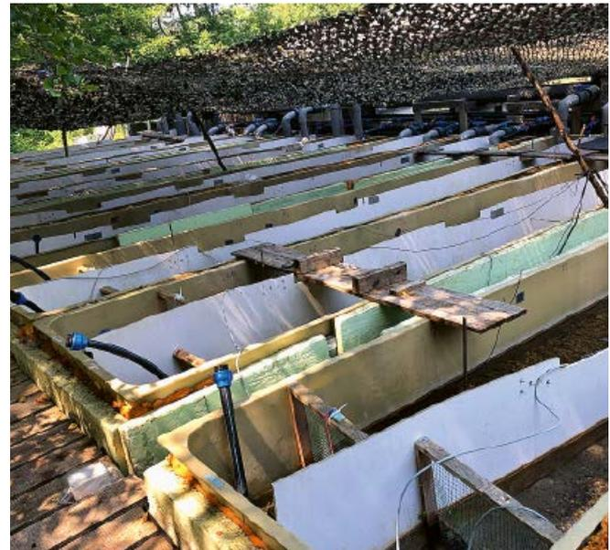
Abb. 6: Aufbau der Fließrinnenexperimente mit Grob- und Feinsedimenten sowie variablen Temperaturen und Flussraten in Freising, Lehrstuhl Aquatische Systembiologie/TUM (Foto: Johannes Barth).
